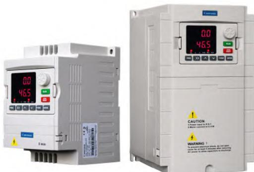
Многофункциональные частотные преобразователи серии CV800 специально разработаны для оборудования малой и средней мощности. В преобразователях используется технология скалярного управления V/f, имеется встроенный ПИД-регулятор, многоскоростное управление, программируемое управление работой, встроенная поддержка протокола Modbus RTU и другие технологии. Компактная конструкция позволяет сократить пространство для установки.
