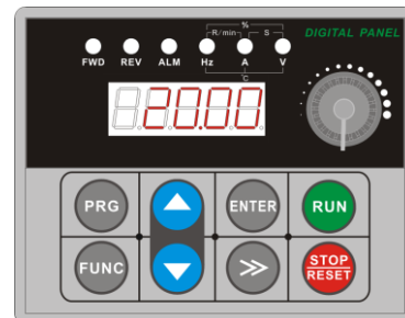
Рис. 3-3 Отображение действующих значений в режиме останова. На дисплее «Выходная частота» «20.00»
